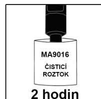
**B** Pokud je pH elektroda znečištěná, vložte ji na 2 hodiny do **čisticího roztoku (MA9016)** nebo do bílého octa.
