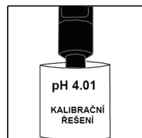
**A** Pokud pH elektroda vyschla, vložte ji na 20 hodin do **skladovacího roztoku (MA9015)** nebo do roztoku pH 4,01 CAL (nebo dokonce do vody z vodovodu).
